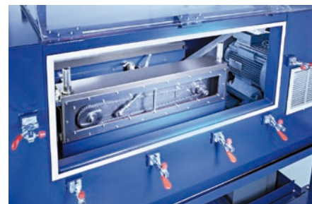
Untersuchung des Verschleißverhaltens auf mehr als 20 Prüfständen Testing of chain wear elongation behaviour on more than 20 test rigs
